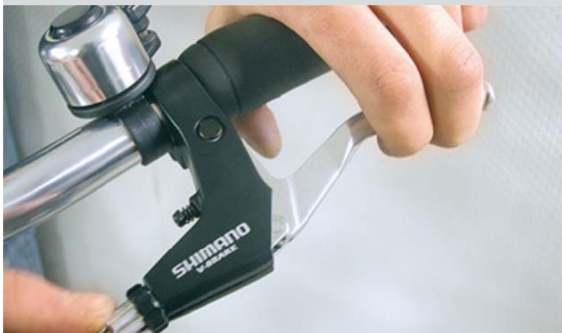
• Einstellung des Bremszugs
