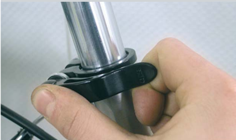
• Öffnen / Schliessen des Schnellspanners Sattelstütze
