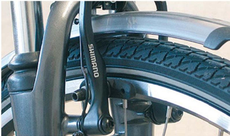
• Vorderradfelgenbremse System V-Breake
