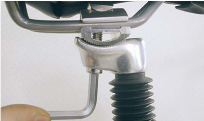
• Ausrichten des Sattels: Neigung und Abstand zum Lenker
