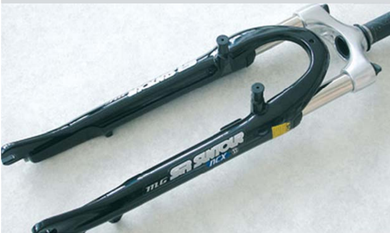
• Vorderradgabel gefedert mit Einstellung der Vorspannung
