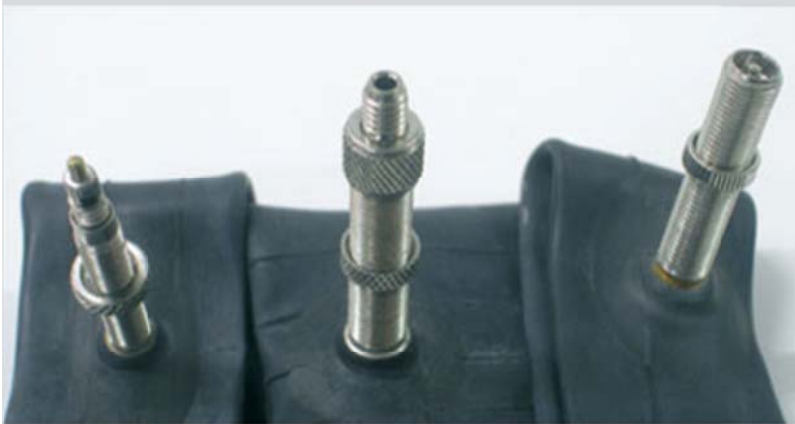
• Ventile (v. li.): Schlauberant- oder Rennventil, Dunlop- oder Blitzventil, Schrader- oder Autoventil
